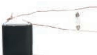
a. L'ampoule (comme les pattes de l'oiseau) touche un seul fil. **L'ampoule ne s'allume pas.**
